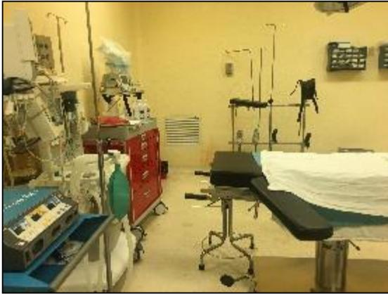
**Foto 25.** En el área de quirófano de acuerdo a reglamento, no cuenta con un piso conductor para evitar descargas eléctricas.
