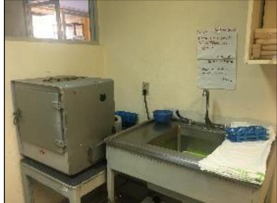
**Foto 38.** Para el área de lavado, no funciona adecuadamente el autoclave, así como el mobiliario se encuentra oxidado.
