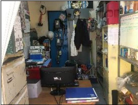
**Foto 61.** La oficina de mantenimiento se encuentra saturada, desordenada y el tablero eléctrico se encuentra obstruido.
